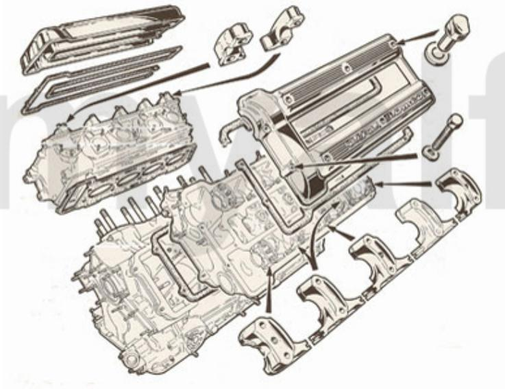
**1 2326450** *Kopfdichtsatz Montreal mit Zylinderkopfdichtungen*
