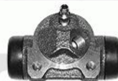
2. 673 178 rechts/right System: Bendix Ø 17,46 mm >1986
