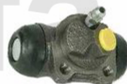
4. 673 399 rechts/right System: Bendix Ø 17,46 mm 1987> - 4x4
